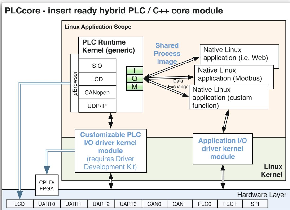
通过数据共享机制 (Share Process Image)，C/C++应用程序可以象调用本地变量一样直接调用PLC变量。为避免无意义的的数据复制，用户可以自己选择保留需要的数据。采用锁定和同步机制防止数据的非一致性，这意味着即使是C/C++应用程序也可以通过数据共享机制 (Share Process Image) 同时读写同一数据。
